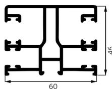
SRM60A - Guida di alluminio a due camere con zanzariera
