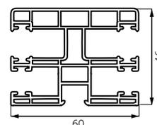
SRM60 - Guida in pvc a due camere con zanzariera
