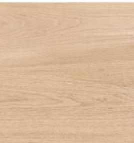
Eichenholz ist hart, sehr dauerhaft und widerstandsfähig gegen Abrieb und mechanische Beschädigungen. Es zeichnet sich außerdem durch eine sehr gute Schalldämmung aus. Es zeichnet sich durch seine Langlebigkeit und Beständigkeit gegenüber wechselnden äußeren Bedingungen aus. Außerdem hat es eine interessante Farb- und Maserungsstruktur, die Eichenholztüren dauerhaft beliebt macht.
