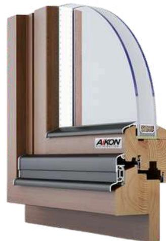
Renovierungshinterschnidungen in Holz können auf einem 106 mm oder 136 mm Rahmen ausgeführt werden. Die maximale Höhe der Renovierungsfräsung beträgt 35 oder 40 mm, die maximale Breite hängt von der Dicke des Profils ab.
