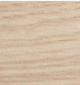
Kiefernholz ist dauerhaft, stark und bietet eine hervorragende Wärmedämmung. Sein hoher Harzgehalt macht es widerstandsfähig gegen die schädlichen Auswirkungen von Feuchtigkeit. Es hat eine helle Farbe und lässt sich gut mit Farben und Lacken sättigen.
